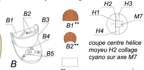
coupe centre hélice moyeu H2 collage cyano sur axe M7
